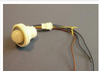
Mini-Bewegungsmelder Sensorreichweite: 4-6m Laufzeit: 3s/45s/4m schaltbar Aktivierung: Immer/Dämmerung/Dunkel schaltbar
